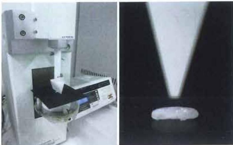
図6 米粒の硬さを測定する様子
