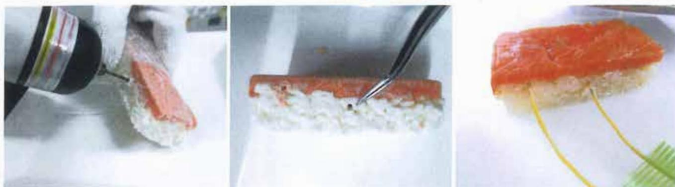
図4 光ファイバーによる温度測定風景
